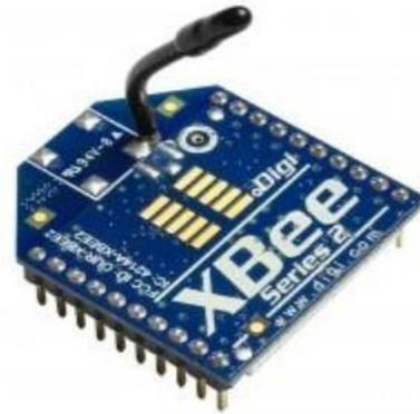
38400 FOR XBEE RADIO
