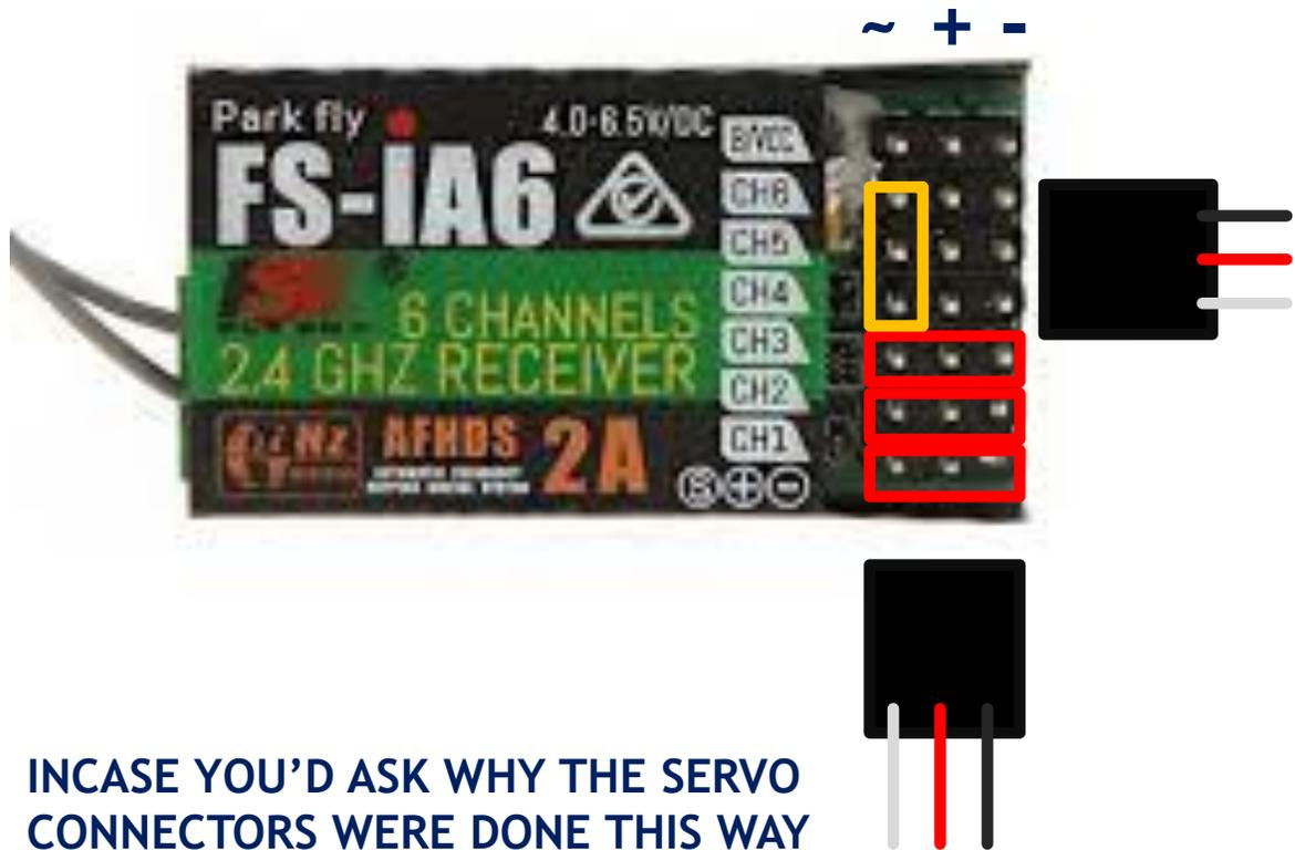
IN CASE YOU'D ASK WHY THE SERVO CONNECTORS WERE DONE THIS WAY , ITS SIMPLY YOU DON'T NEED TO PLUG ALL THE PWM POWER RAILS ON ALL CHANNELS YOU JUST NEED THE PWM SIGNAL PIN ALONE MOSTLY RUDDER AUX1 AND AUX2
